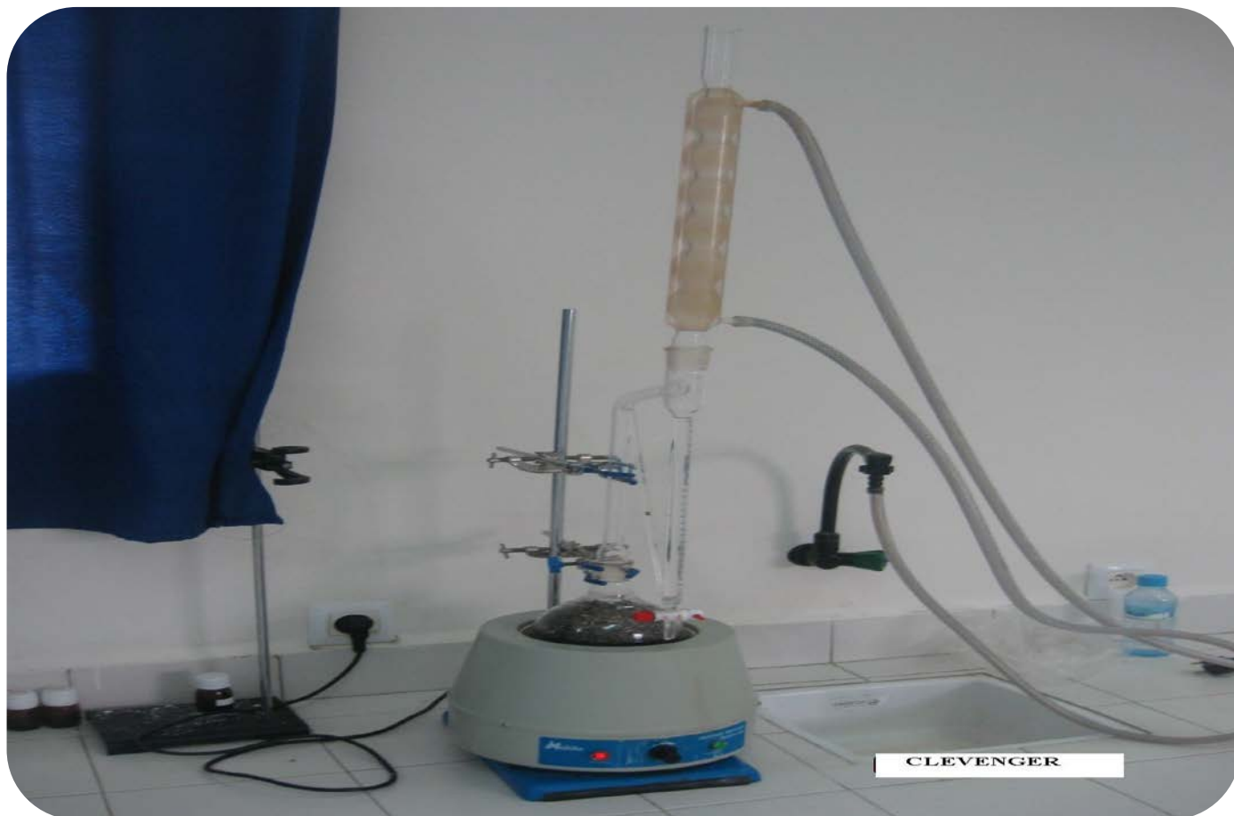
Appareil d'hydrodistillation "Clevenger"
