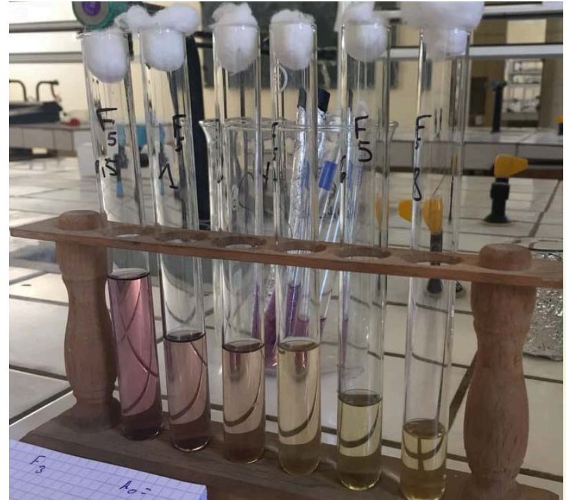
Figure 2: Activité antioxydante du mélange tertiaire par la méthode piégeage les radicaux libres DPPH
