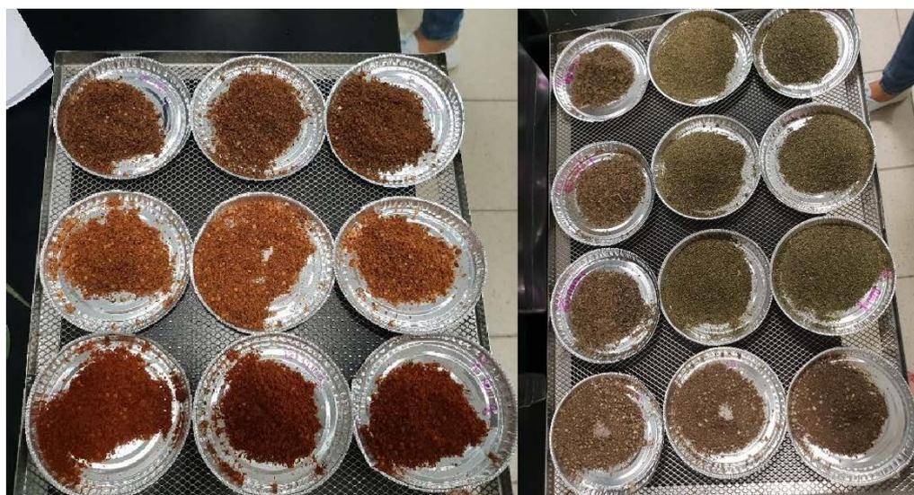
Figure 3 Coupelles de pesée avec les échantillons broyés mis à l'étuve
