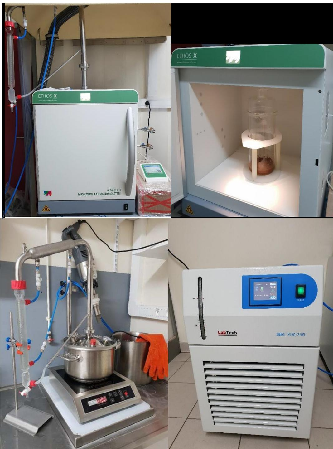
Figure 6 Extracteur micro-onde avec cuve en verre et support téflon (haut) ; turbo-distillateur avec cuve inox ; cryothermostat (bas)
