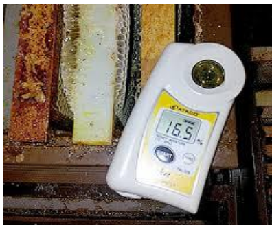
Photo 38 : Prise d'humidité sur cadre à l'aide d'un réfractomètre numérique
