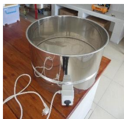
Photo 48 : Bac chauffant (introduire le contenant à l'intérieur).
