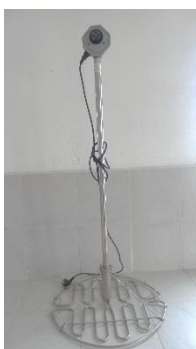
Photo 47 : Défieur de miel (inox). A insérer directement dans le maturateur.
